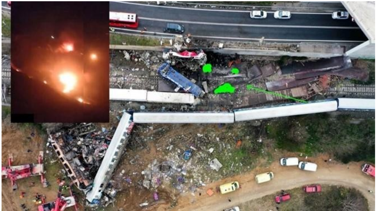
Εικόνα 64. Πυρκαγιά στο εσωτερικό του μετασχηματιστή της εμπορευματικής αμαξοστοιχίας ως δευτερεύον αποτέλεσμα πυρκαγιάς στην «λίμνη» #1.
