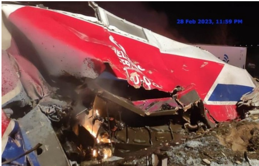
Εικόνα 65. Τοπική πυρκαγιά μέσα και έξω από τον σπασμένο μετασχηματιστή της πρώτης ατμομηχανής της εμπορευματικής αμαξοστοιχίας, 40 λεπτά μετά την ατύχημα.
